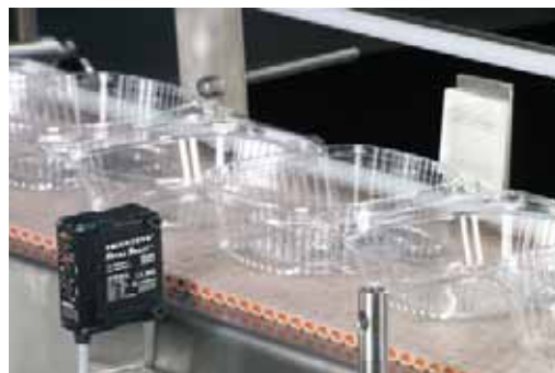
Détection du bord d'objets à formes irrégulières sans signaux fantômes.
